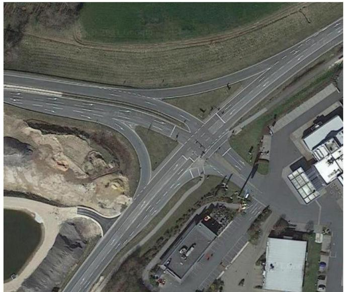
Die Signalanlage am KP 3 läuft vollverkehrsabhängig in zwei Teilknoten.<sup>1</sup> Bei Stau in der Autobahnausfahrt wird eine Sonderphase geschaltet. Die Rückfallebene am Teilknoten 1 besteht aus einer Festzeitsteuerung mit sechs Phasen. Die Fußgängerquerung und die Rechtsabbieger von Haag kommend werden als separater Teilknoten betrieben (TK2). Die vorliegenden verkehrstechnischen Unterlagen werden als Grundlage verwendet.
